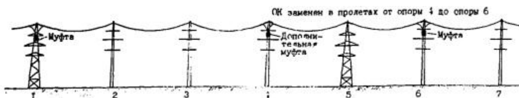
б) Состояние линии после замены ОК
